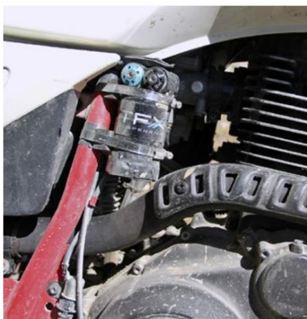
Il montante a molla accessorio di TFX sulla parte posteriore dell'XT funziona in modo molto soddisfacente
