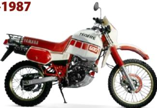
Mit der **1VJ** wollte Yamaha Gutes noch verbessern und erreichte das genaue Gegenteil. Aufgrund von Überhitzungsproblemen starben die Motoren reihenweise und ruinierten das Image des unzerstörbaren Fernreiseschiffs. Der neue, optisch größere Tank fasste leider nur noch 23 Liter.
