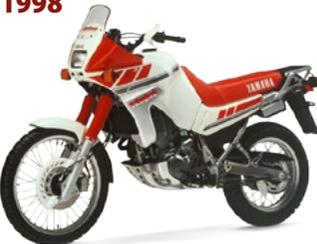
Die **XTZ 660**, das erste wassergekühlte Ténéré-Modell, kokettierte mit Fünfventil-Technik und war mehr auf Straßenbetrieb ausgelegt: Kürzere Federwege und 195 Kilo Gewicht bedeuteten wenig Spaß offroad. Ab 1994 verpassten ihr die Techniker eine größere Verkleidung samt Doppelscheinwerfer, was den bescheidenen Verkaufserfolg jedoch nicht verbesserte und das Gewicht um zwei Kilo erhöhte.
